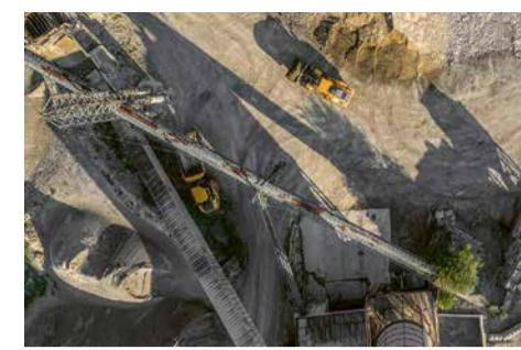
Rohmaterialzufuhr ab Abbaustelle Tuleu, Paspels per Förderband in die Kiesaufbereitungsanlage der Beton und Kies AG Unterrealta.
